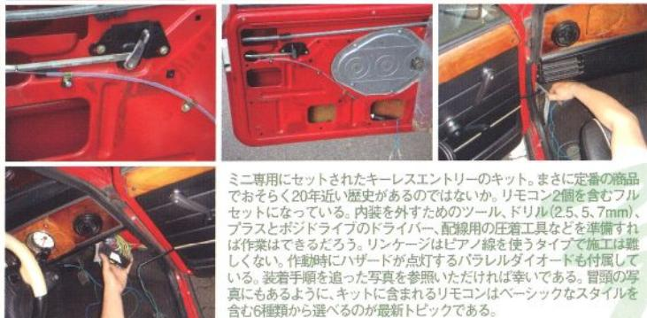
ミニ専用にセットされたキーレスエントリーのキット。まさに定番の商品でおそらく20年近い歴史があるのではないか。リモコン2個を含むフルセットになっている。内装を外すためのツール、ドリル(2.5、5.7mm)、プラスとボジドライバー、配線用の圧着工具などを準備すれば作業はできるだろう。リシーバーはピアノ線を使うタイプで施工は難しくない。作動音がハザードが点灯するパラレルダイオードも付属している。装着手順を追った写真を参照いただければ幸いである。冒頭の写真にあるように、キットに含まれるリモコンはベーシックなスタイルを含む6種類から選べるのが最新トピックである。
