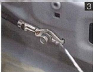
3 ラストストッパーの装着は、あっけないほど簡単。要はバッテリーとアース線をつないで、パルス線をボディに取り付ければおしまい。1.まずは、本体から伸びる赤色の配線を、バッテリーのプラスターミナルに接続する。2.次に、黒色の配線を、バッテリーのマイナスターミナルに接続する。3.最後に、クリア皮膜のパルス線を、ボディの金属部分(車種により、配置箇所は異なるが、例えば、エンジンルームやシートレールのボルト部分など)に装着すれば完了だ。
