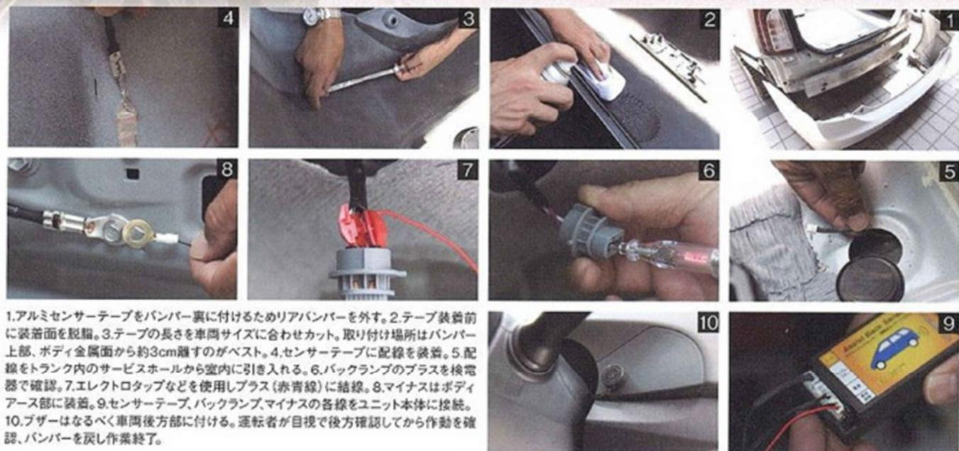
1.アルミセンサーテープをバンパー裏に付けるためリアバンパーを外す。2.テープ装着前に装着面を脱脂。3.テープの長さを車両サイズに合わせカット。取り付け場所はバンパー上部、ボディ金属面から約3cm離すのがベスト。4.センサーテープに配線を装着。5.配線をトランク内のサービスホールから室内に引き入れる。6.バックランプのプラスを検電器で確認。7.エレクトロタップなどを使用しプラス(赤青線)に結線。8.マイナスはボディアース部に装着。9.センサーテープ、バックランプ、マイナスの各線をユニット本体に接続。10.ブザーはなるべく車両後方部に付ける。運転者が目視で後方確認してから作動を確認、バンパーを戻し作業終了。
