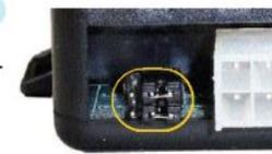
上段のジャンパー設定はLOCK/UNLOCK信号の出力時間の設定端子で、右寄せにはめると0.5秒(標準設定)、左寄せにはめると3.5秒(エアポンプ等で動作する信号の長い車用)となります。
